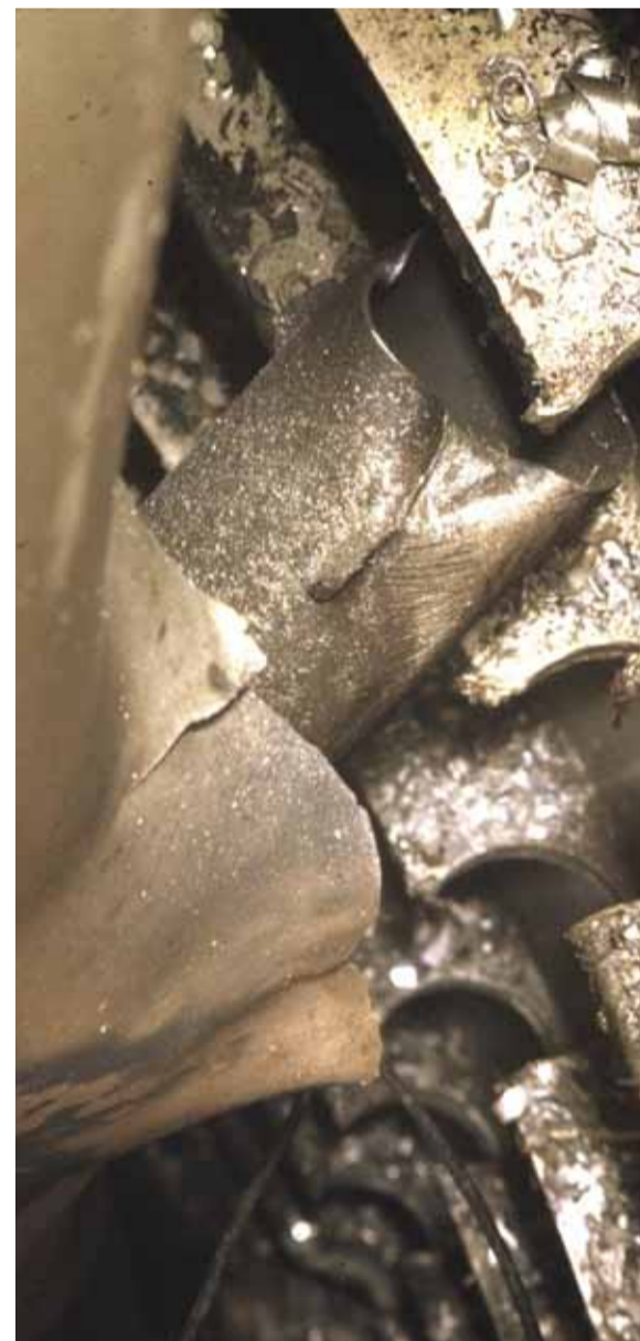
Gesprengtes Brennstabhüllrohr in Lucens Quelle ENSI
